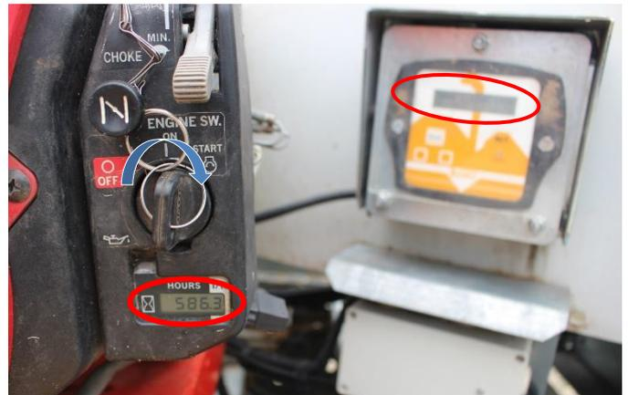
L'affichage du compteur moteur et du boîtier de régulation électronique apparaissent.
