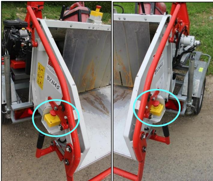
Pour reprendre le travail, tourner le bouton d'urgence **SANS FORCER** dans le sens des aiguilles d'une montre pour le relever en position de fonctionnement.
